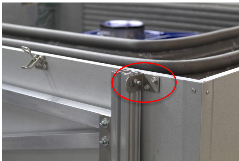
Kuva 8: Kulmakiinnike rungon yläreunassa.
