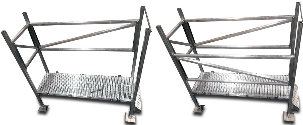
Kuva 7: Säädä ulkokaide 1100mm tason pinnasta ja sisäkaide koneen rungon mukaan oikeaan korkeuteen.
